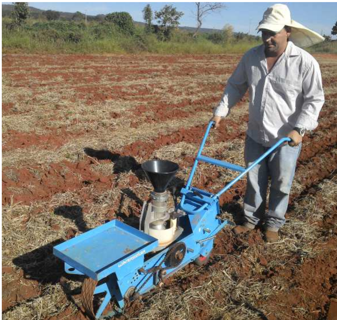
Figura 5B. Semeadora regulada para distribuição uniforme das sementes em oito metros de comprimento do sulco por parcela, na Embrapa Cerrados, Planaltina, DF.
