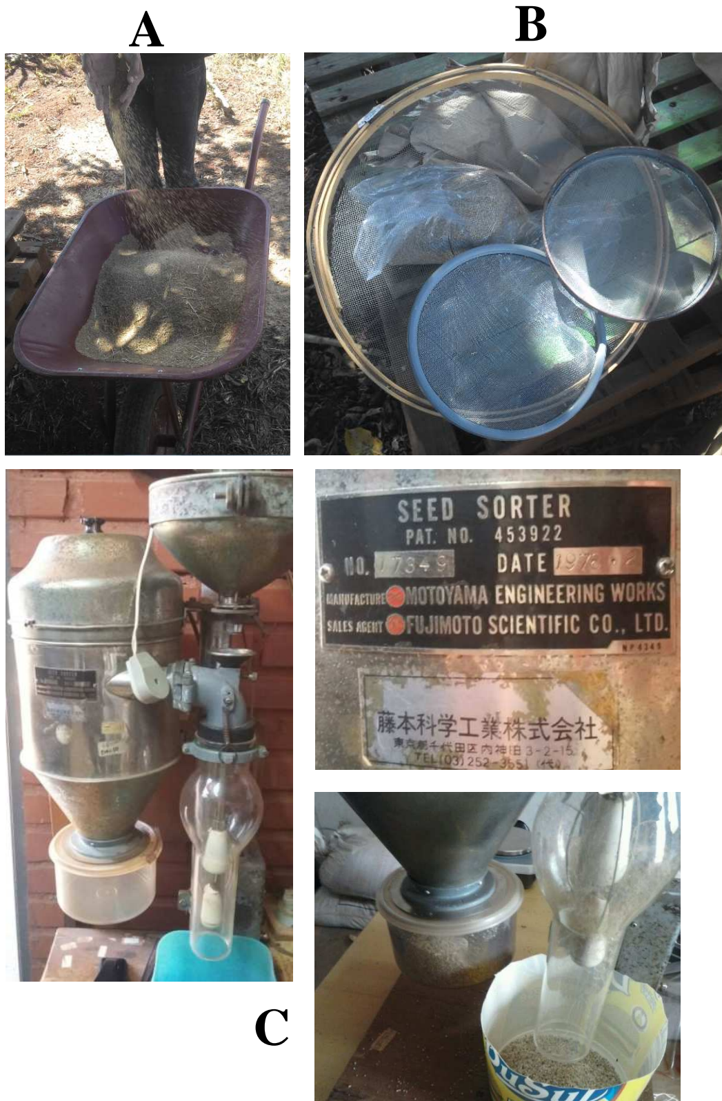
Figura 7B. Separação dos resíduos da inflorescência e infrutescência dos grãos, com ação do vento (A), uso de peneiras de malhas variadas (B) e separador e classificador de sementes a vácuo (C), na Embrapa Cerrados, Planaltina, DF.
