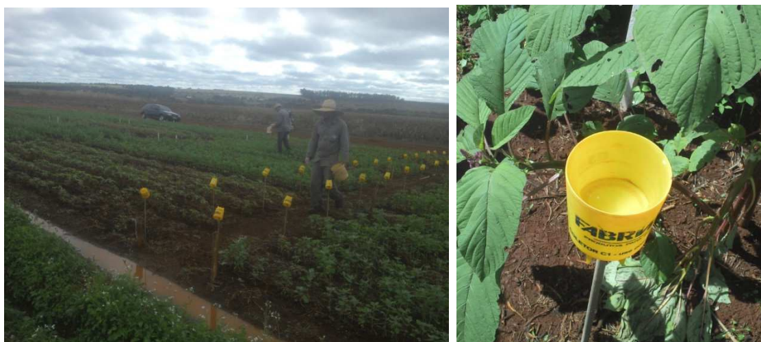
Figura 2B. Coletores universais para conferência da lâmina aplicada com quatro centímetros de raio, na Embrapa Cerrados, Planaltina, DF.
