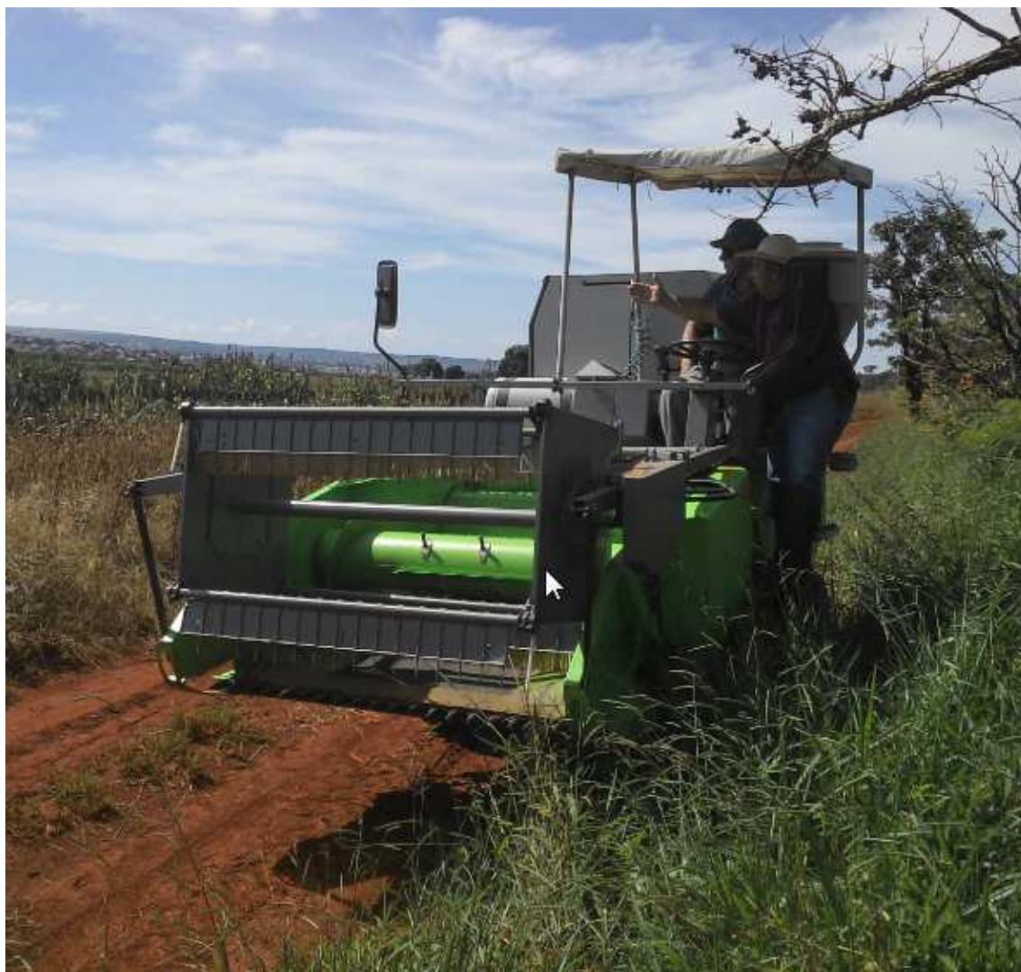
Figura 6B. Colhedora de parcelas experimentais para trilha de duas linhas de semeadura nas parcelas constituídas com 8 linhas, na Embrapa Cerrados, Planaltina, DF.
